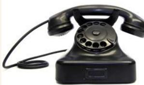
**1936** telefono a batteria centrale, automatico
